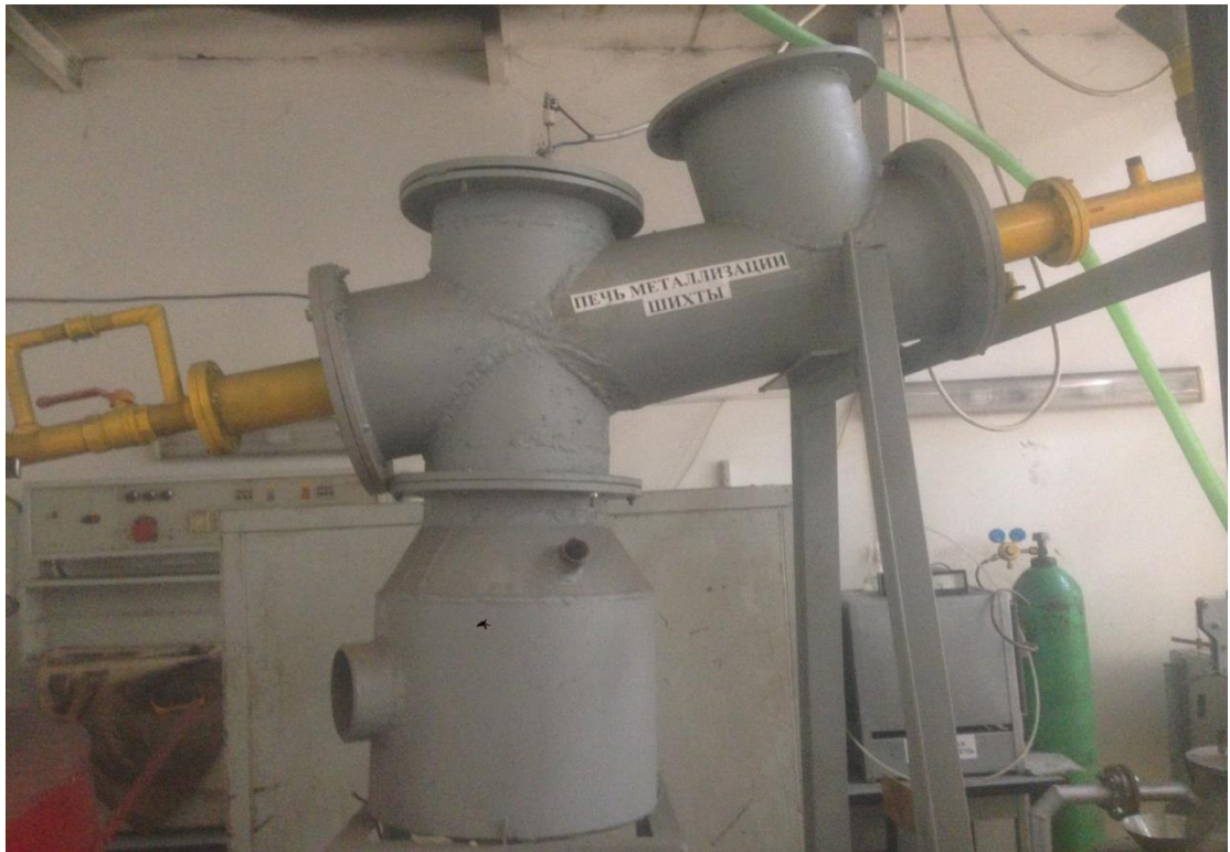
2.1 Сурет – Шихтаны металдандыруға арналған шахталық пеш
